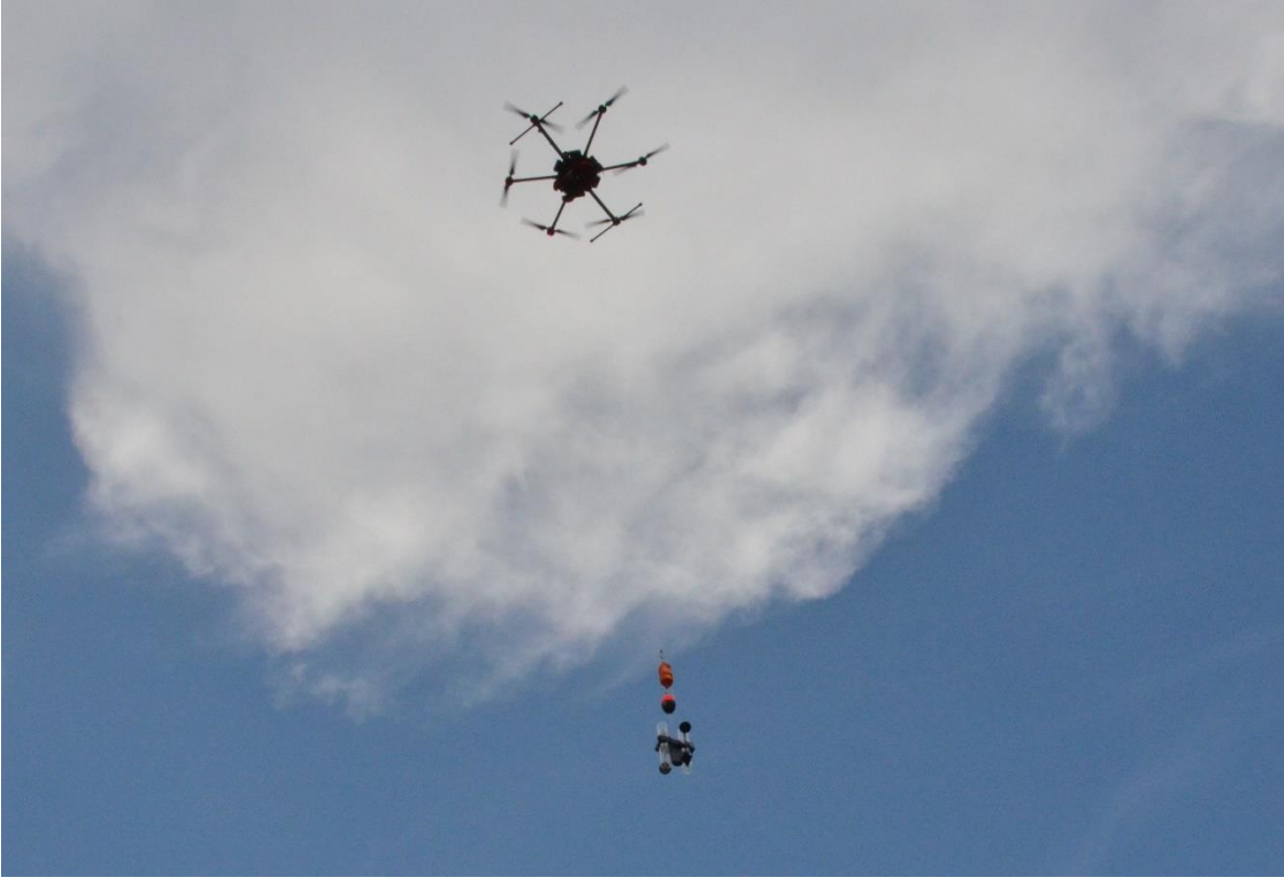
Kuva 1. DJI Matrice 600 matkalla vesinäytteenottoon Kittilän Pahtavuomassa (kuva Tatu Lahtinen/GTK).
