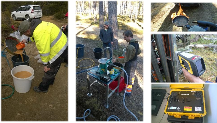
Kuva 1. Indika-projektissa testattuja kenttämenetelmiä moreeninäytteiden konsentroidmiseksi ja analysoimiseksi.
