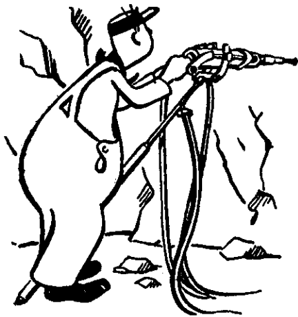
Kallioporakone RH-655 W polvisyöttöineen.
