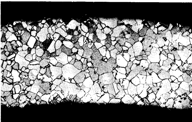
Kuva 7. Välittömästi puristuksen jälkeen vesijäähdytetyn putken kiderakenne.
