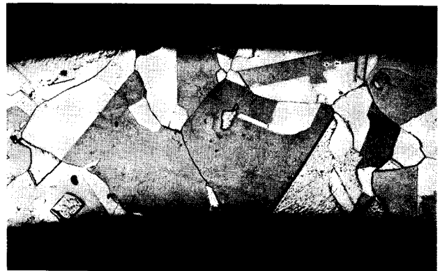
Kuva 10. Ilman jäähdytystä puristettu, kuumana kelalle ajettu putki.
