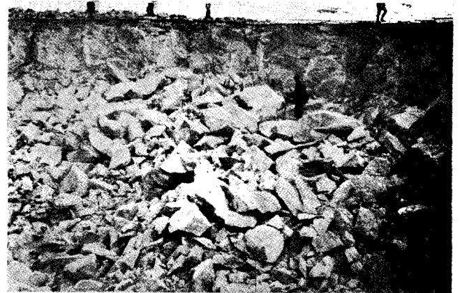
Kuva 7. Hidasteisesti sytytetty intervalli 10 millisek. Molemissa reiät 8 m, etu 2,5 m, reikäväli 2,0 m, reikälukumäärä 16 ja räjähdysainetta 130 kg.
