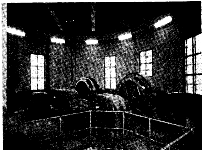
Kuva 3. Keretin Koepe- 2-köysinostokoneet. Vasemmalla malminnostokone, oikealla henkilönostokone.
