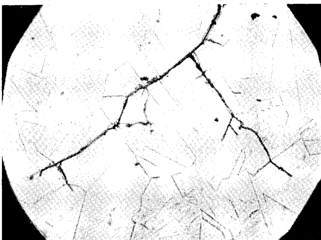
Fig. 14. Spänningskorrosionsspricka i 18/8-stål, större förstoring.
