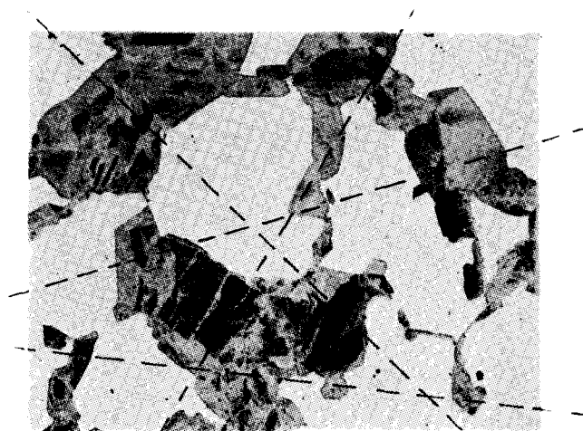
Kuva 2. Erkautuneen vyöhykkeen tilavuusmurto-osan määrittäminen viivasuhdeanalyysillä. Merkityn tarkastuksen tuloksena saadaan x_v \approx 0.4 (Cu + 4.2 % Cd-seos).
