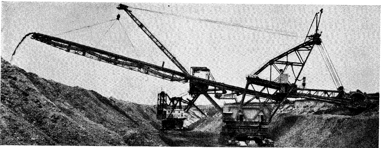
▲ Leikkuripyörällä varustettu jättiläiskaivukone, jonka BUCYRUS-yhtymä on suunnitellut ja rakentanut United Electric Coal Companylle. Työpaino on 2.100 tonnia ja keskimääräinen maansiirtoteho 2.600 kiintokuutiometriä tunnissa. Maksimisiirtomatka 126 m.
