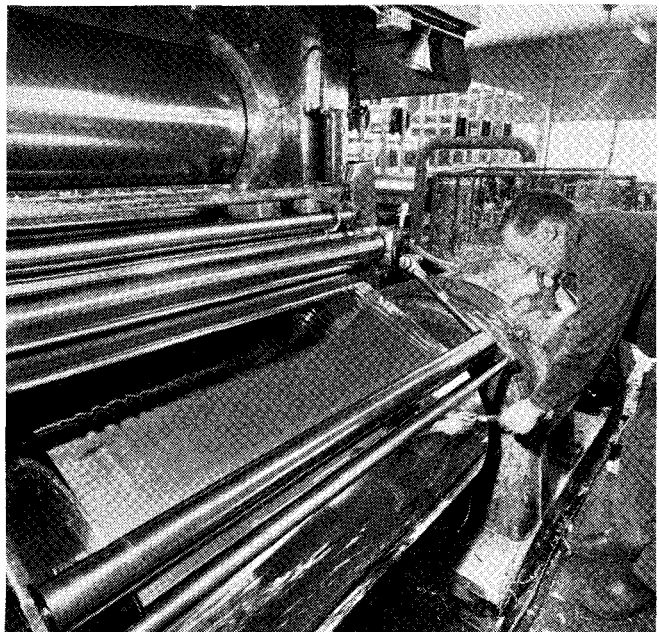
Valssikoneen toinen puoli. Valmista alumiinifoliota kiertymässä puolalle läpikäytyään valssausvaiheen.
