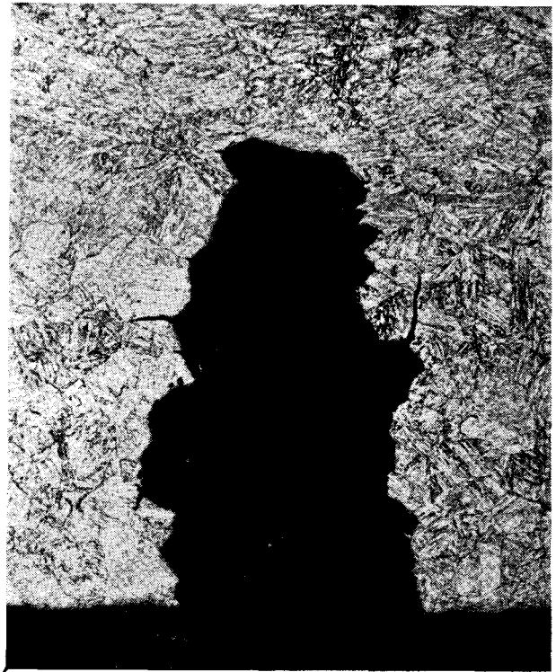
Kuva 11. Kiderakente avautuneen raon ympäristössä, sama teräs kuin sauvoissa kuvassa 8. Suurenus 150 × — AB Bofors. (K. Lounamaa, kts. kuva 8.)
