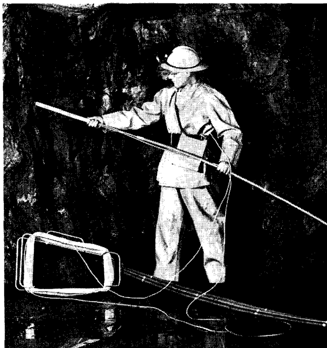
Malmin magnetiittipitoisuuden mittausta Susseptimetrillä.
