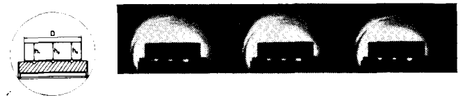
Kuva 2. Vasemalla: Kaaviokuva mitattavista dimensioista. Oikealla: Kappale dilataatiofilmiä.
