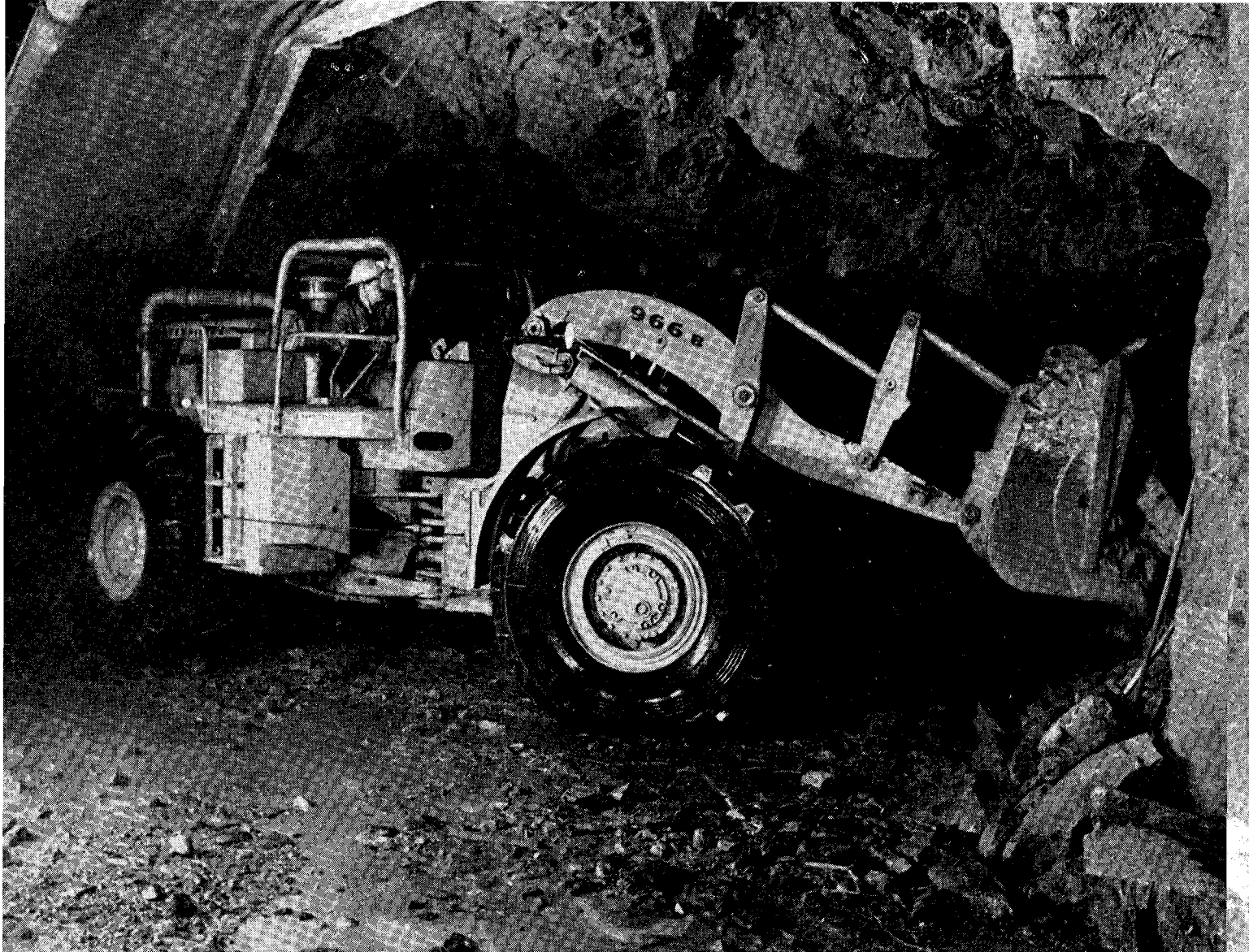
Matalaprofiilinen Caterpillar 966 pyöräkuormaaja työssä suomalaisella kaivoksella.
