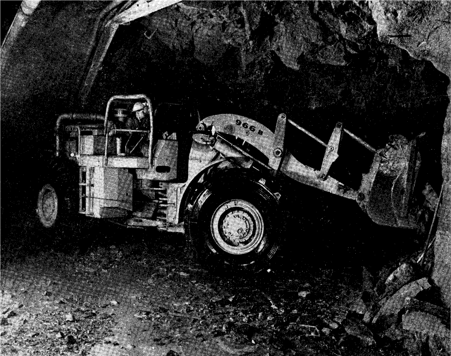
Matalaprofiilinen Caterpillar 966 pyöräkuormaaja työssä suomalaisella kaivoksella.
