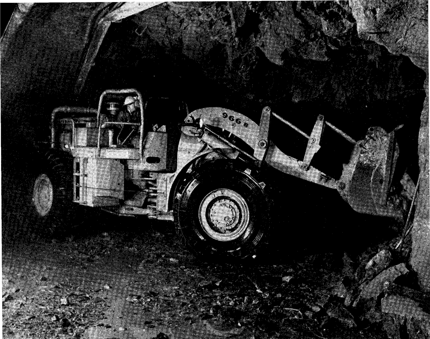
Matalaprofiilinen Caterpillar 966 pyöräkuormaaja työssä suomalaisella kaivoksella.
