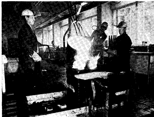
Kuva 1. Muottiin valetaan pallografiittivalurautaa, jonka jäähtymistä seurataan termoelementeillä 12 eri pisteestä. Fig. 1. Casting of SG iron. The cooling curves are measured with thermocouples at twelve points.
