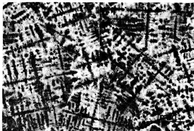
Kuva 3. Primäärin jähmettymisessä syntyneen raerakenteen ja dendriittirakenteen välinen yhteys hiiliteräksessä.
