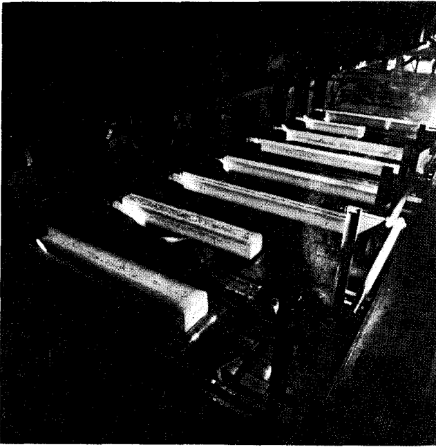
Kuva 2. Suuria teelmiä, 255 × 330 mm, valava kahdeksan-tankoinen kone, jonka panospaino on 250...270 tonnia. Kuvassa teelmät tulevat ulos leikkureilta.
