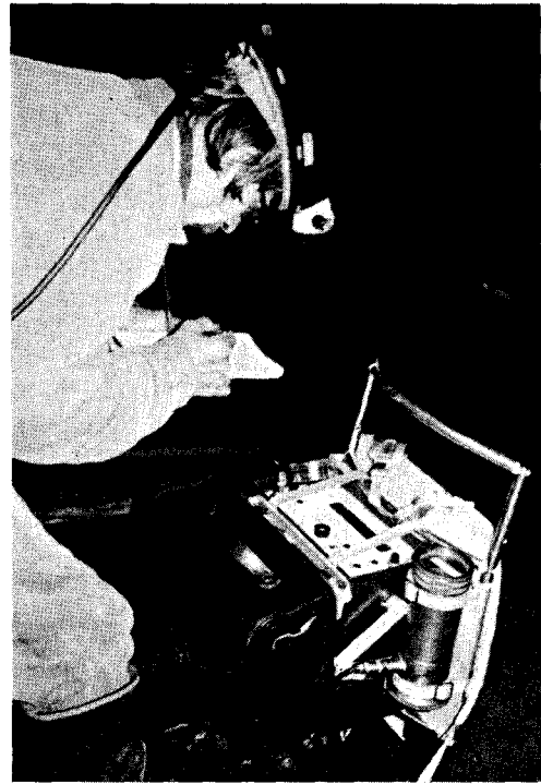
Kuva 2. Hajoamistuotteiden pitoisuuden mittaaminen kaivoksessa 1-kanavaisella pulssinkorkeudenanalysaattorilla.
