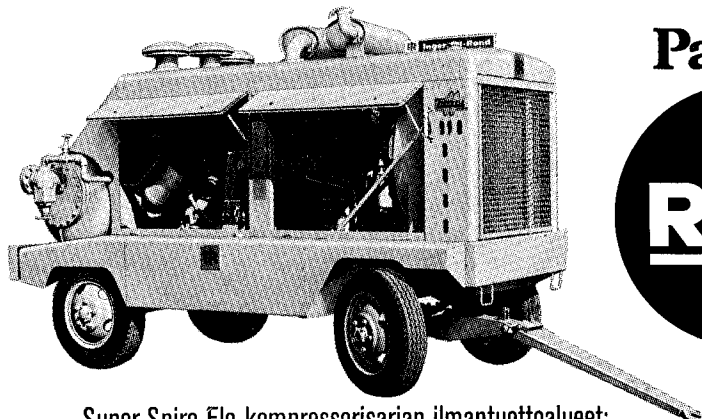
Super Spiro-Flo-kompressorisarjan ilmantuottoalueet: 21,3 - 56,6 m 3 /min.
