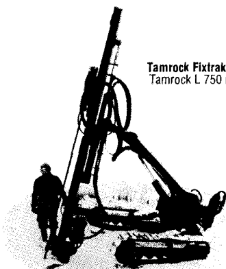
550 EA Tuotto 15,5 m 3 /min Suurin jatkuva työpaine 8,0 bar Tehontarve 7,0 bar paineella ja täydellä tuotolla 86 kW
