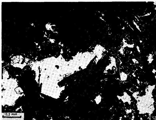
Kuva 4. Repaleista kuparikiisu-, pentlandiitti- ja magneetti-kiisupirotetta (valkoinen) kummingtoniittikivessä.
