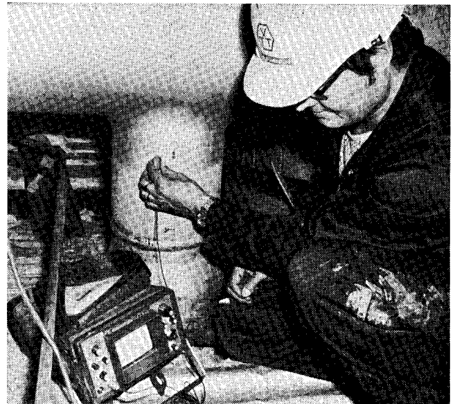
Kuva 8. Ruostumattomasta teräksestä tehdyn komponentin ja hitsausliitoksen ultraäänitarkastus vaatii usein erikoismenetelmiä ja -luotaimia.
