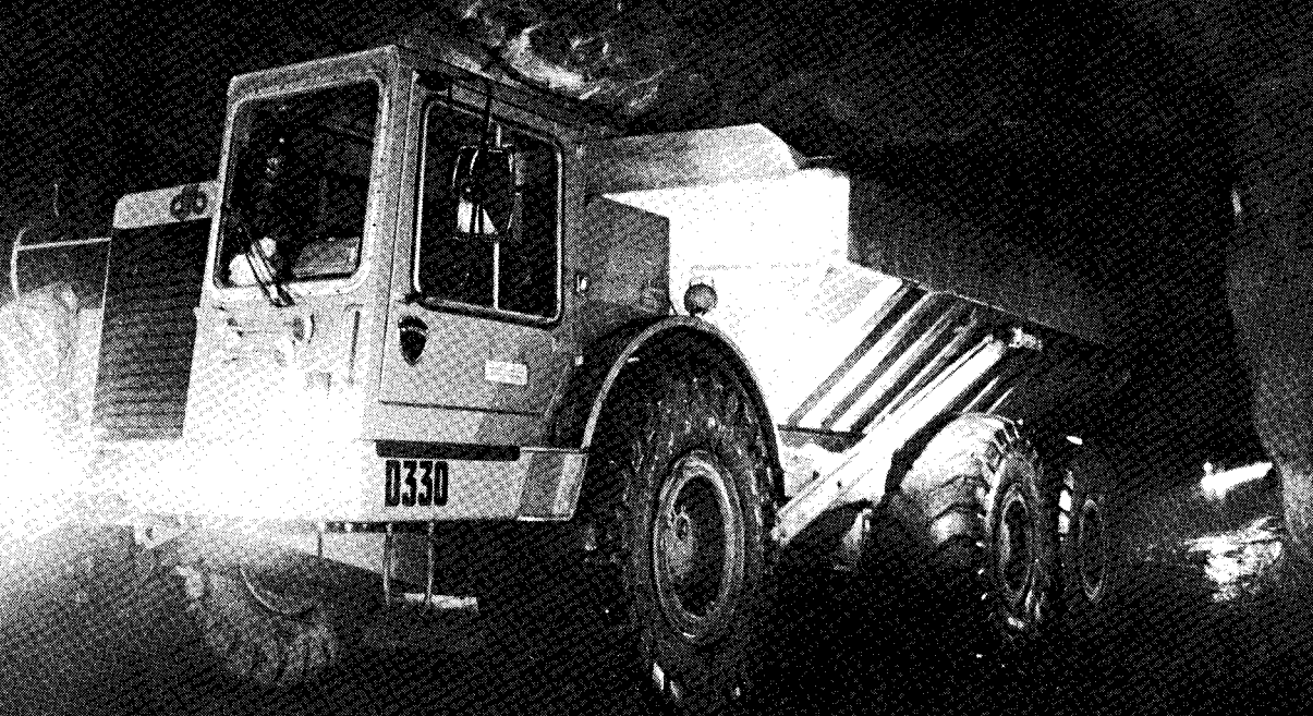
DJB D330 louheenssiirrossa Outokumpu Oy:n Vammalan kaivoksessa. Koneen omistaa Lastaus E. Kärjä & Pojat, Kalajoki.
