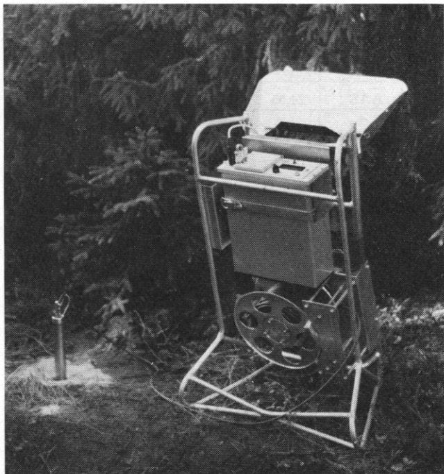
Kuva 13. Porareikäanalysointilaitteen anturi mittamassa lyhyttä pintareikää.
