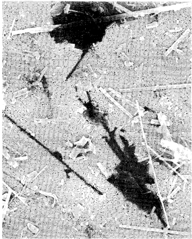
Kuva 8. Antofylliittikuituja Nuclepore-suodattimella; Tuusniemi, Paakkila. (Suurennus 2000 x; 1 cm = 5 µm).
