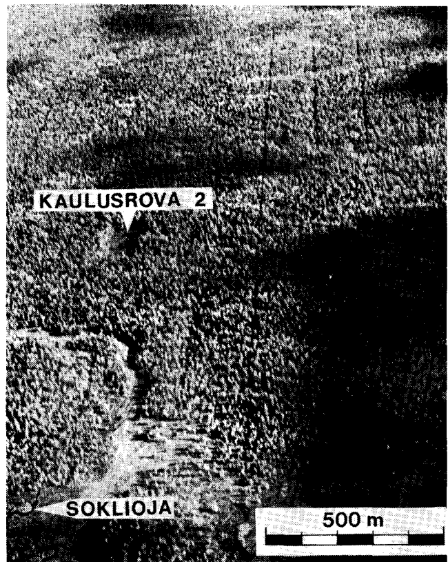
Kuva 4. Näkymä Kaulusrovan Nb-malmialueelle. Pitkät tummat viivat ovat tutkimusojia. "Kaulusrova 2" osoittaa paljastetun Nb-malmion.
