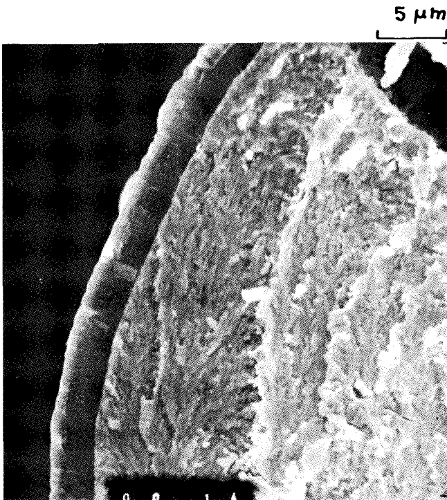
Kuva 8. Reaktiivisella rf-sputteroinnilla muodostettu TiC-pinnoite W-langan pinnalla. Pinnoituslämpötila 900° C.
