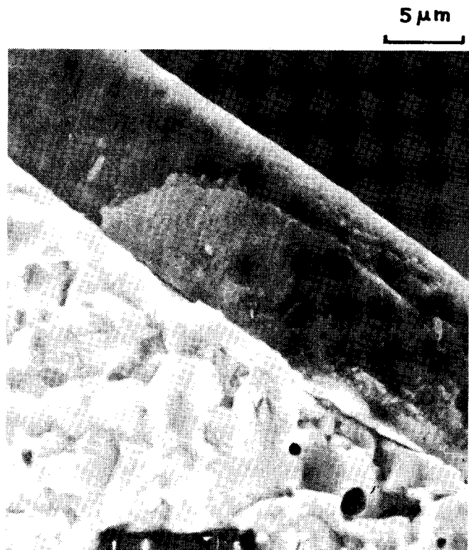
Kuva 5. CVD-menetelmällä muodostettu TiC-pinnoite työkaluteräksen pinnalla. Fig. 5. TiC coating produced by CVD on a tool steel.
