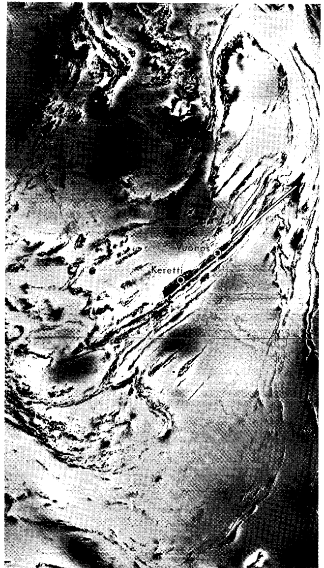
Kuva 2 a. Aeromagneettinen harmaasävykuva Outokummun (ylempi) ja Heinäveden lentomittausalueilta. Mittaukset: Geologinen tutkimuslaitos 1980, 1981. Tulosten käsittely: Outokumpu Oy ja Valtion teknillinen tutkimuskeskus. Maksimiarvot on merkitty mustalla, minimi valkoisella ja näiden väliin jäävät arvot harmaaan eri sävyillä. Keretin ja Vuonosin sijainti on merkitty, samoin tekstissä mainittu Vuonosin — Kylynlahden poimurakenteen akselin maanpintaprojektio.
