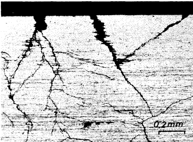
Kuva 4. Kloridin aiheuttamia jännityskorroosiomurtumia austeniittisessä 18/10/2,5-tyyppisessä ruostumattomassa teräksessä.
