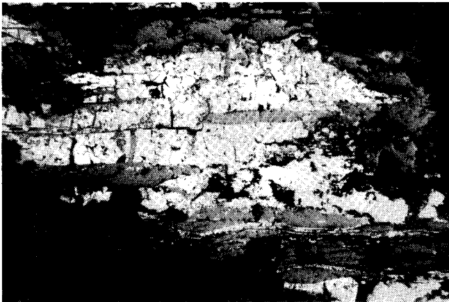
Kuva 4. Hituran välimassaa, jossa pentlandiittia, magneettikiisiä ja mackinawiittia. Magnetiitti ympäröi pentlandiittia, n. 225 x. Fig. 4. Pentlandite, pyrrhotite and mackinawite in the serpentinized central part of Hitura orebody. Magnetite surrounds pentlandite, approx. 225 x.
