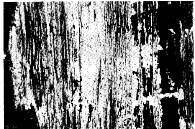
Kuva 6. Vammalan peridotiittia: osittain serpentiiniytyntä oliviinia, pyrokseenia ja serpentiiniä. Ohuthie, n. 24 x. Fig. 6. Vammala peridotite: partly serpentinized olivine, pyroxene and serpentine as minerals. Thin section, approx. 24 x.
