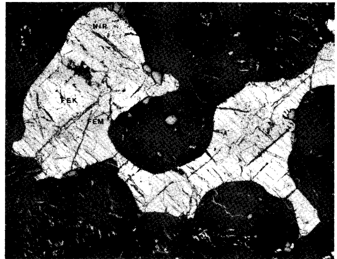
Kuva 5. Tiheä magnetiittiverkko Vammalan pentlandiitissa, mackinawiittipölyä serpentiinissä, 39 x. Fig. 5. A dense magnetite net in pentlandite of Vammala ore, mackinawite dust in serpentine, 39 x.
