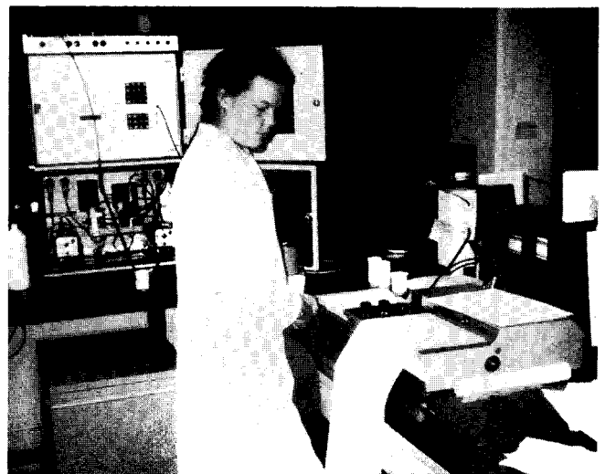
Kuva 12. Vesinäytteiden analysointia voltammetrillä. Fig. 12. Analyzing water samples using the voltammeter.
