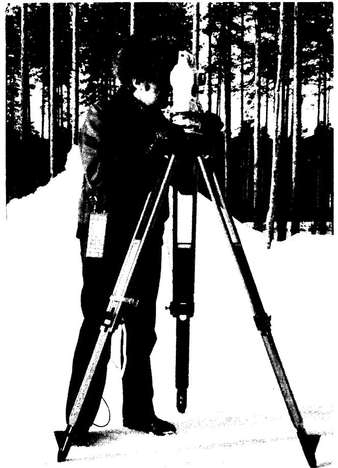
Kuva 6 KTP-84 maanmittaus- ja kaivosmittaussovellutuksissa. Fig. 6. Topographic surveying using KTP-84 computer.
