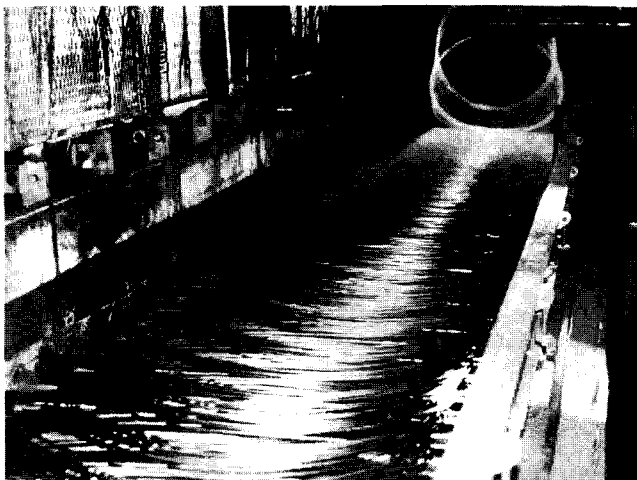
Bild 4. Den kontrollerade kylningen möjliggör valsning av mycket krävande kvaliteter, som valsas med en hastighet av hela 80 meter per sekund. Årsproduktionen uppgår till 180.000 ton.
