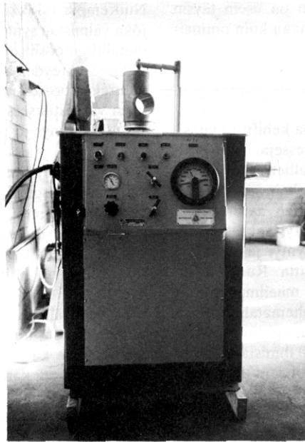
Kuva 2. Nestepaineekammio kylmäisostaattista puristusta (CIP) varten. Fig. 2. Cold isostatic press.
