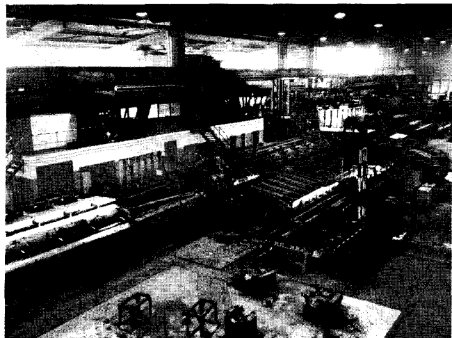
Bild. 1. Rörverk i Hofors. På bilden syns uppvärmningsugn, hålverk och Assel verk.
