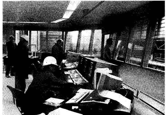
Kuva 4. Valukoneen pääohjaamo. Pöydällä automaatiojärjestelmän näyttöpäätteet, katon rajassa sisäisen TV-valvontajärjestelmän monitorit.
