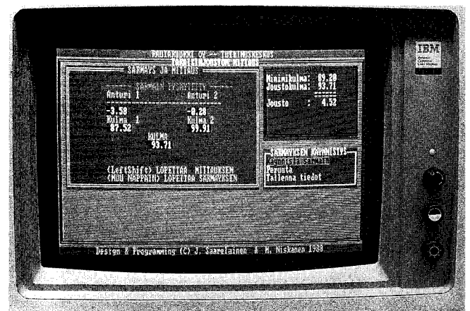
Kuva 3. Mikrotietokoneen kuvaruudun näyttö takaisinjoustonmit- tauksen tapahduttua. Särmäyskulmat näkyvät kuvaruudun oikeassa yläkulmassa. Fig. 3. Presentation of springback measurement on PC screen.
