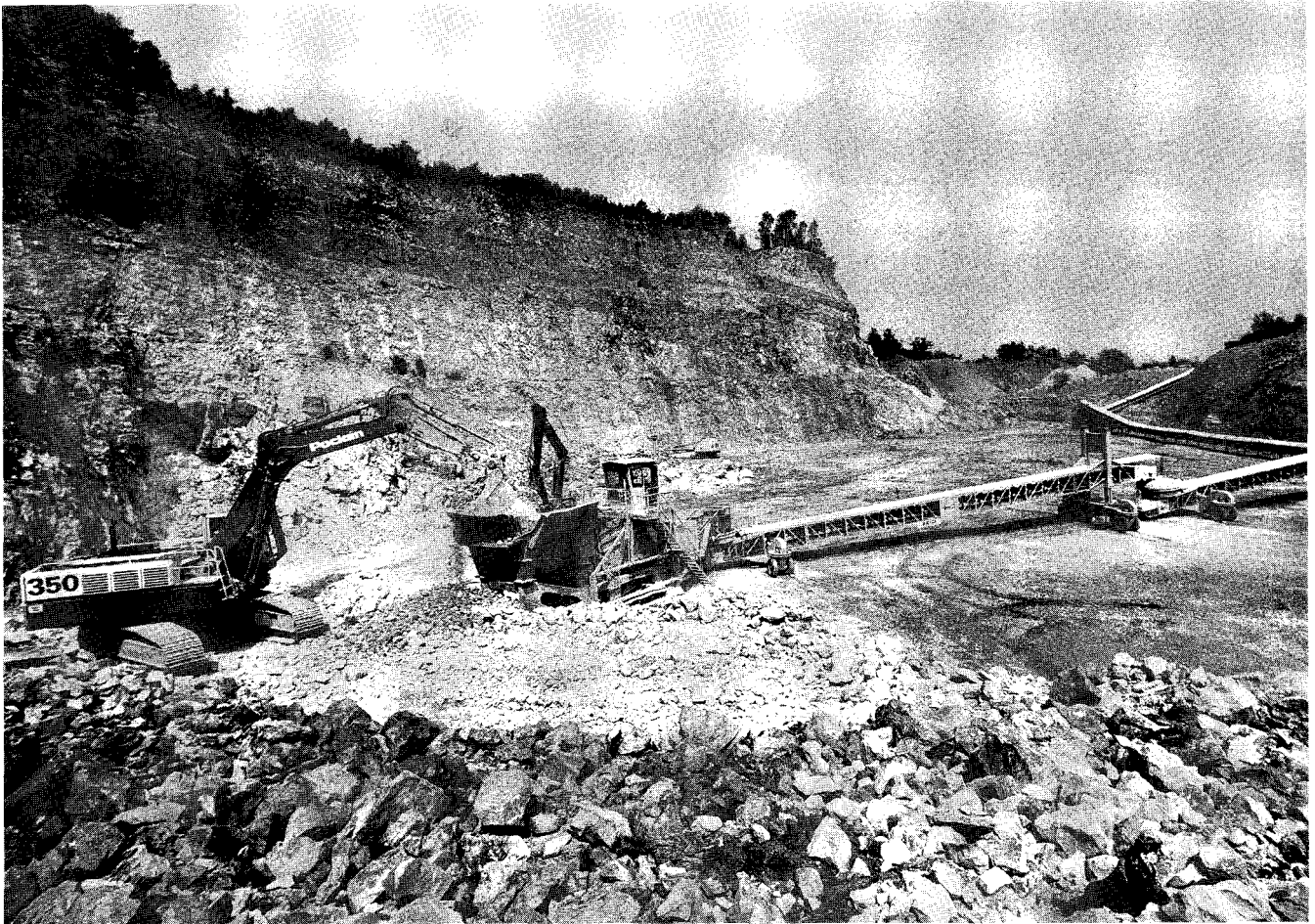
Kuva 4. Itseliikkuviin, tela-alustaisiin murskausyksiköihin perustuva Lokotrack-järjestelmä on viime vuosien harvoja todellisia uutuuksia murskausalalla. Lokotrack-esimurskain yhdistettynä liikkuviin kuljettimiin on tehokas ja sisäisiä kuljetuskustannuksia merkittävästi säästävä järjestelmä, joka soveltuu erinomaisesti esimerkiksi maanpäälliseen kaivostoimintaan.
