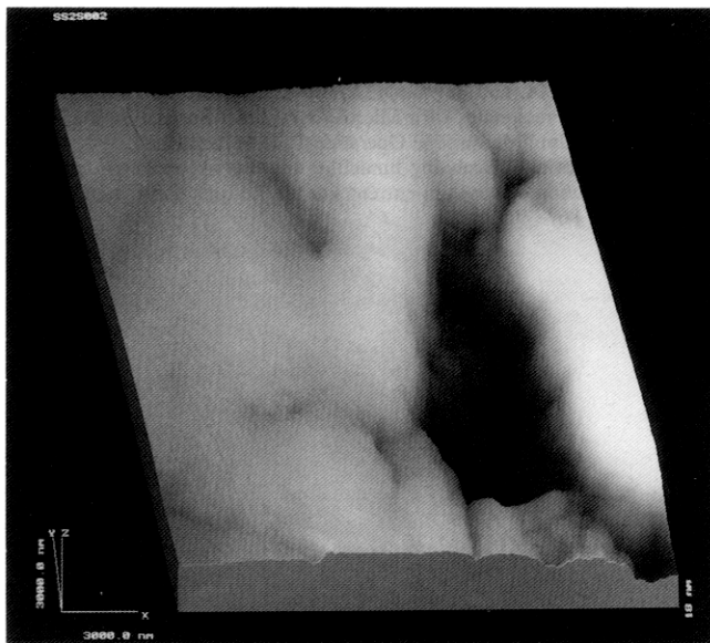
Kuva 8. STM kuva Ar^+ ionisputteroidusta ruostumattomasta teräksestä, jossa raerajat ovat sputteroituneet selektiivisesti. Fig. 8. STM picture of the effects of Ar-ion sputtering on stainless steel surface.
