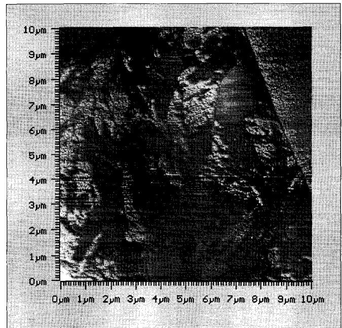
Kuva 3. AFM-kuva poikkileikatusta TiN-pinnoitetusta työkaluteräksestä. Perusaineen martensiittinen rakenne näkyy kuvassa. Fig. 3. Atomic force micrograph of TiN coated tool steel. The martensitic structures of the substrate are clearly visible.
