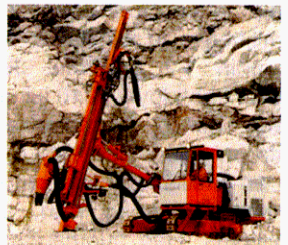
Tamrock 公司的 DH600S 型液压与气动锤击式挖掘机，由 Han Yang 公司订购有 16 台这种装置。
