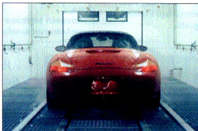
Porsche Boxter vesitiiviytestissä Valmet Automotiven tehtaalla Uudessakaupungissa. Kuva: Valmet Automotive.
