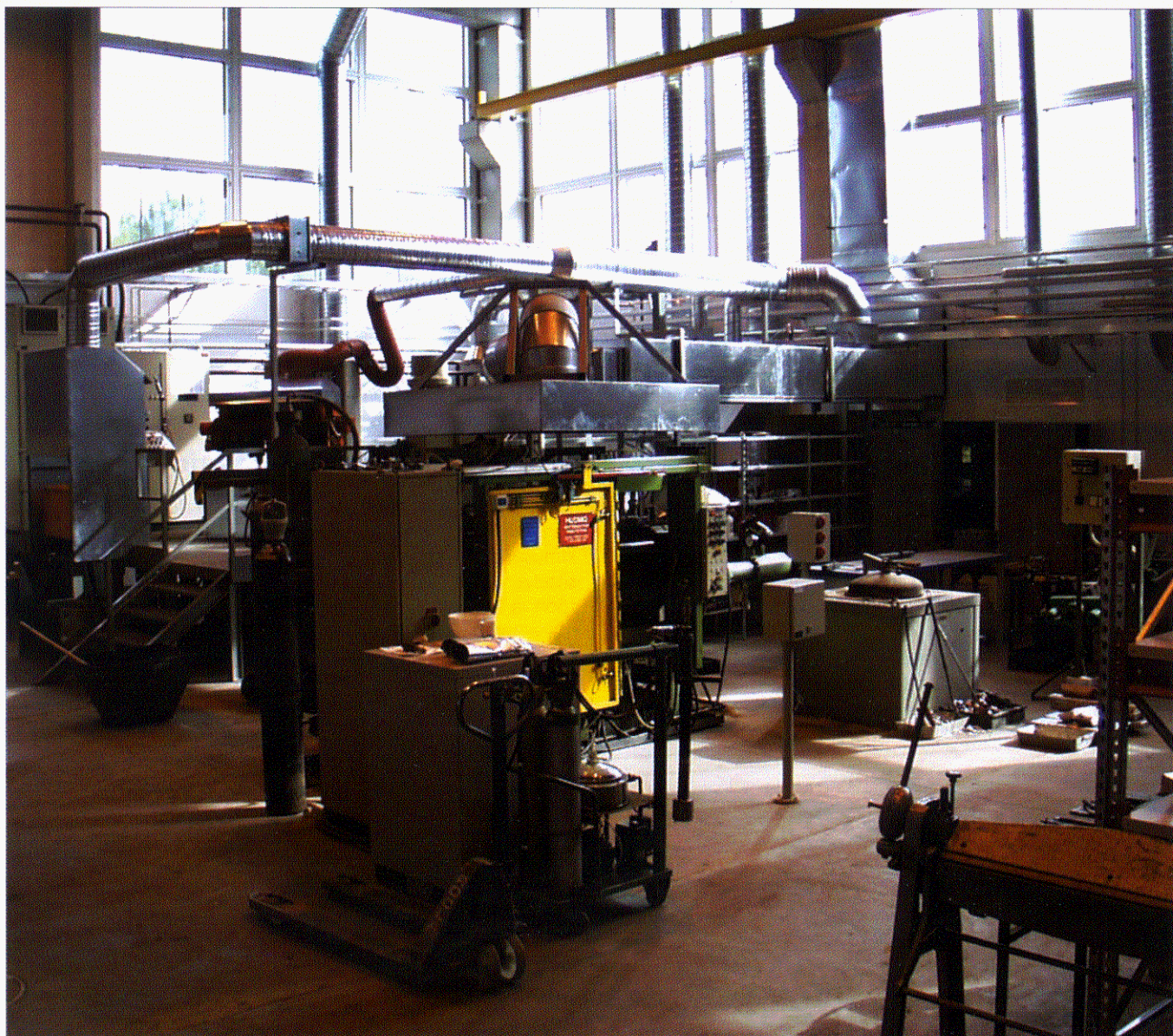
Kuva 10. Valimoinstituutin kestopuottilaboratorio korkea- ja matalapainevalukoneineen.
