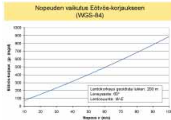
Kuva 4. Eötvös-korjauksen (pystyakseli) riippuvuus lentonopeudesta v (vaaka-akseli), arvoilla leveysaste \phi = 60^\circ N, korkeus merenpinnasta h = 200 m, ja lentosuunta \beta on W-E. [\delta g_E] = \text{mgal} ja koordinaattijärjestelmänä WGS-84.
