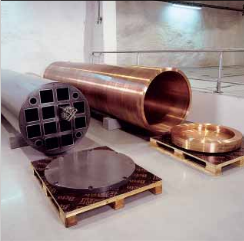
Loppusijoituskapselin prototyyppi valmistui vuonna 1999. Vasemmalla pallografiittivaluraudasta valmistettu sisäosa ja oikealla 5 cm paksu kuparilieriö. Kuva: Posiva Oy.
