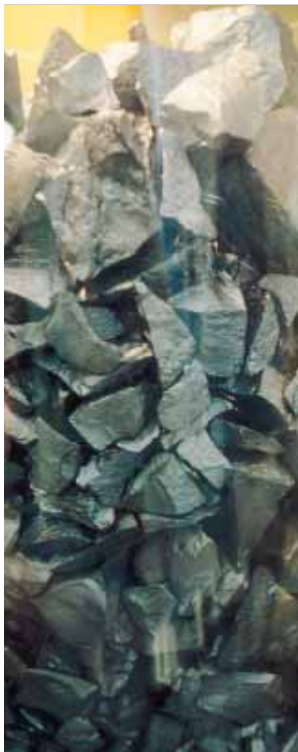
Okmetic käyttää monikiteiseksi polypiksi jalostettua piitä raaka-aineena.
