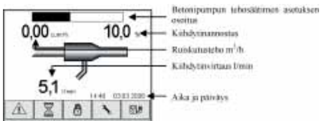
Kuva 7. NORDOSER näyttötaulu ruiskutuksen aikana. Figure 7. NORDOSER main display during shotcreting.
