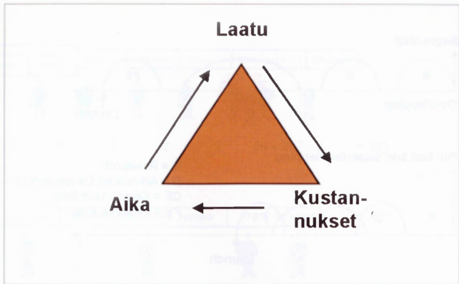
Kuva 2. Agiilin valmistuksen tärkeimmät elementit ovat aika, laatu ja kustannukset. Ensimmäin otetaan aika hallintaan, jolloin laatuvaikutteet ja laaduton toiminta paljastuu ja laaduttomuuden juurisyitä voidaan poistaa. Lopuksi tulevat kustannussäästöt.
