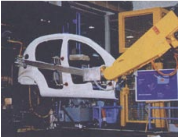
Kuva 3. CCV-konseptin mukaista korinvalmistusta robottivusteisella ruiskuvalukoneella. (Chrysler/Plastforum 12/1997)
