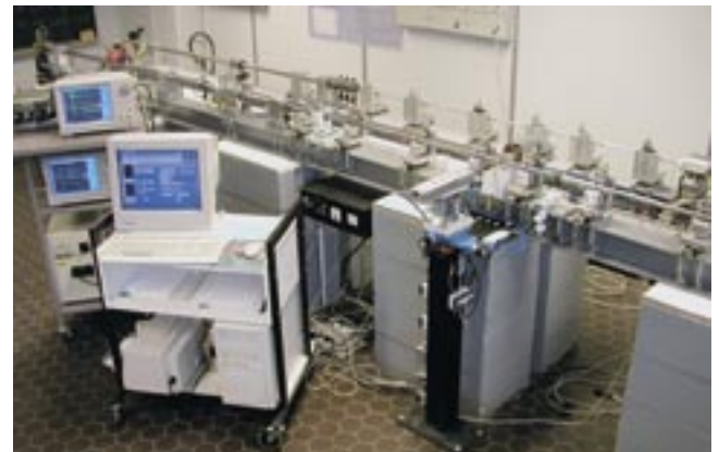
Kuva 7. Hopkinson-puristuskoelaitteet TTY:n Materiaaliopin laitoksella. Figure 7. The compressive Hopkinson Split Bar devices at the Institute of Materials Science in TUT.
