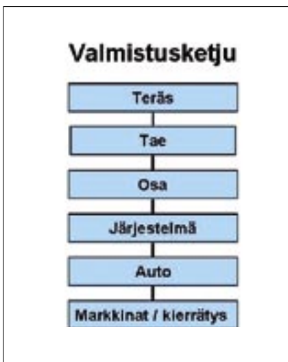
Kuva 1. Tankoteräksen valmistusketju kokonaisuudessaan.
