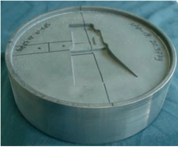
Kuva 7. PSF-menetelmällä valmistettu kuumantaontamuotti (vasemmalla) ja painevalumuotti-insertti (oikealla). Fig. 7. A forging die-insert (left) and a pressure die-casting insert (right) made by PSF process.
