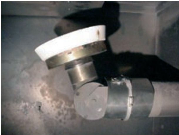
Kuva 5. (a) Muotin sijoitus sulakerrostuskammiossa ja (b) muotin sulakerrostuksen muuttujat. Fig. 5. (a) Ceramic mold in deposition chamber and (b) mold variables in spray.
