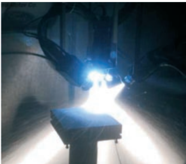
Kuva 2. (a) Oxfordin yliopiston muottivalmistuksen kaariruiskutuslaitteisto ja (b) laitteistolla valmistettu muottikuori [9].
