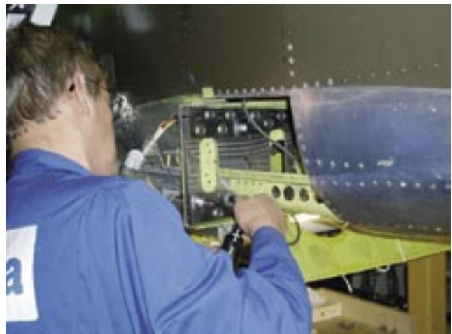
Kuva 4. Rungon keskipalkissa olevien siiven kiinnitysreikien halkaisija kasvatettiin 10 mm:stä 11 mm:iin.
