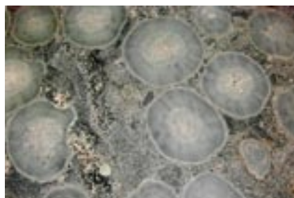
Graniittista pallokiveä Savitaipaleen Ruskiavuoren louhoksesta. Pallojen läpimitta 15-20 cm. Kuva: Seppo I. Lahti, GTK
