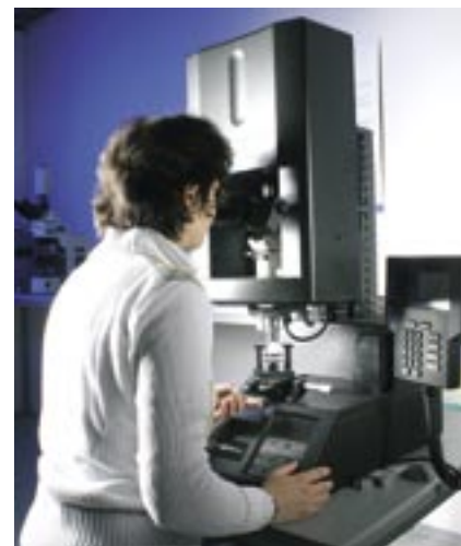
Kuva 7. Knoop'in kovuuden määrittäminen Stone Polen laboratorioissa. Kuva: Stone Pole Oy
