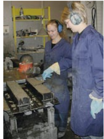
Teekkarit Camilla Vornanen (vas.) ja Katri Junna valavat Camillan diplomityöhön liittyviä koekappaleita TKK:n rakennusmateriaalitekniikan laboratoriossa. Tutkimuskohteena ovat betonin hybridirakenteet. Palkit pannaan viikoksi 95 %:n ja kolmeksi viikoksi 65 %:n suhteelliseen kosteuteen, jonka jälkeen niiden taivutusvetolujuus määritetään rakennetekniikan koehallissa.
