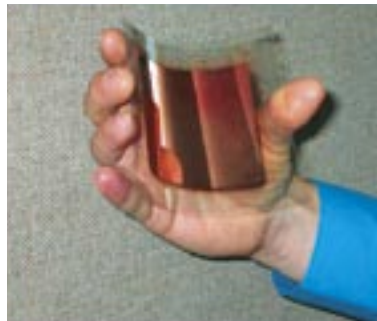
Kuva I. Väriaineherkistetyt nanorakenteiset aurinkokennot lämpöenergiaa ja toimintaperiaate. Kennon toiminta perustuu luonnon fotosynteesin matkimiseen. Esimerkki taipuisasta ohutkalvopolymeerikennosta. Kuvien © Janne Halme, TKK ja Lawrence L. Kazmerski, NREL, USA.
