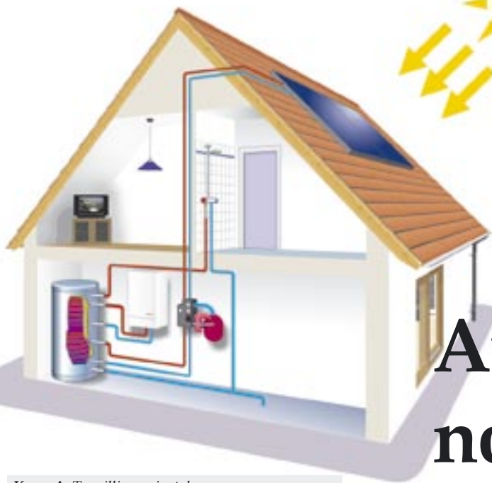
Kuva A. Tyypillinen pientalon aurinkolämpöjärjestelmä käyttöveden lämmitykseen. Keskeiset komponentit ovat 5 m 2 lämpökeräimiä, varaaja, pumppu ja ohjausyksikkö. Kuvan © ESTIF/Solarpraxis
