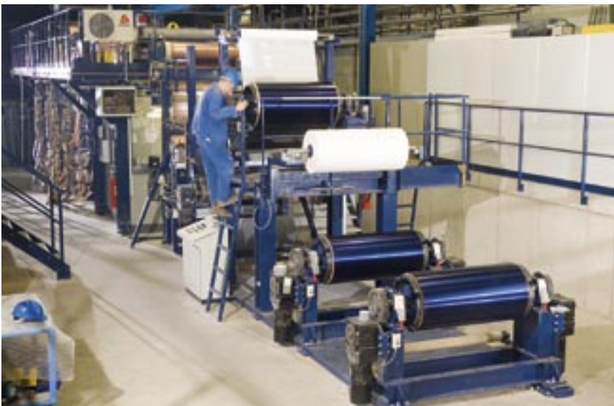
Kuva F. Aurinkokeräinten absorptiopintojen sputterointipinnoitusta. Kuvan © BlueTec GmbH & Co KG.
