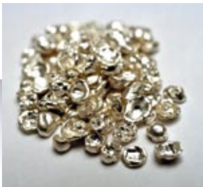
Hopea valetaan rakeiksi. Hopean puhtausaste on vähintään 99,97 %.
