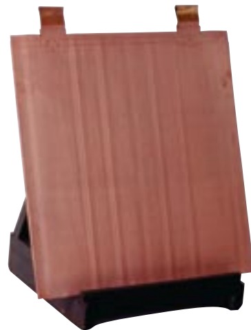
Kuparikatodeja valmistetaan vuosittain noin 125 000 tonnia. Yksi kuparikatodi painaa noin 120 kiloa. Kuparipitoisuus on vähintään 99,995 %.
