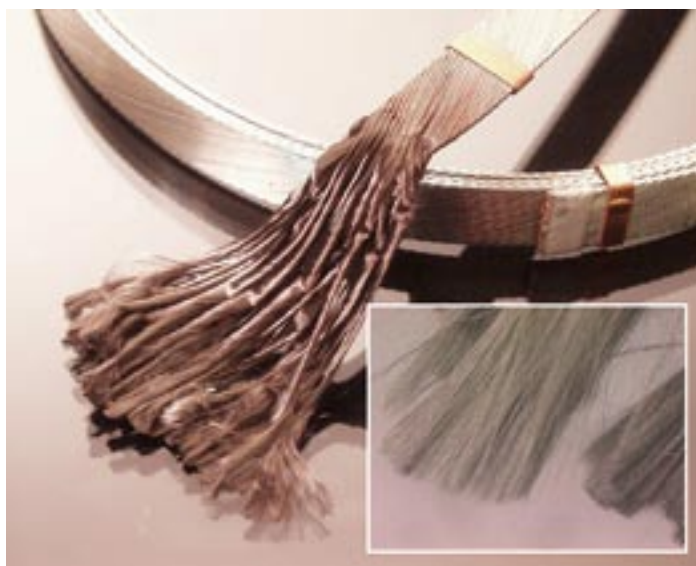
6400 NbTi-filamenttia sisältävästä suprajohtinlangasta valmistettu kaapeli.
