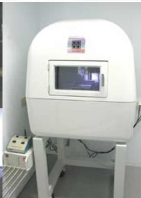
Triboindenter-laitteisto Nordic Hysitron laboratorion puhdastilassa. Vasemmalla mittauspää koteloitun (oikealla) sisällä. Laitteisto on suojattu ulkoisilta värähtelyiltä aktiivisilla värähtelyvaimennuselementeillä. Tämä osaltaan mahdollistaa indenterin kärjen pystysuoran sijainnin 0,2 nm tarkkuudella määrittämisen mittausten aikana.
