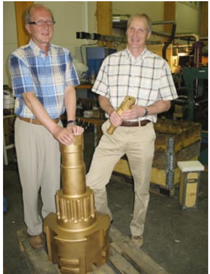
Jorman edessä Ranskaan lähdössä oleva, 406 mm paalujen poraukseen käytettävä terä, Vesalla kädessään Japaniin tarkoitettu tunneliterä.
