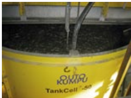
TankCell®-50 vaahdotuskennon tilavuus on 50 m 3 . Vahto kennon pinnalla on kupari-sulfidia.
